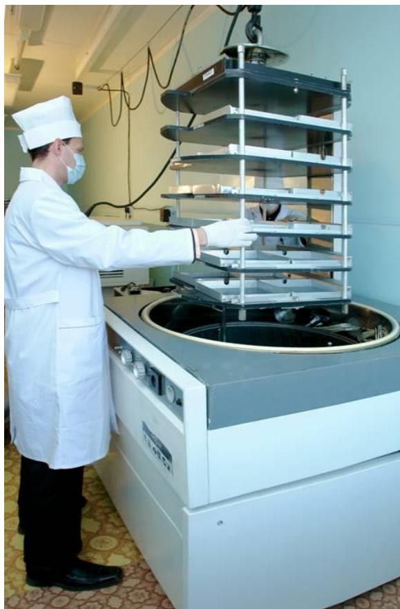
Установка для сублимационной сушки биопрепаратов LZ-45
