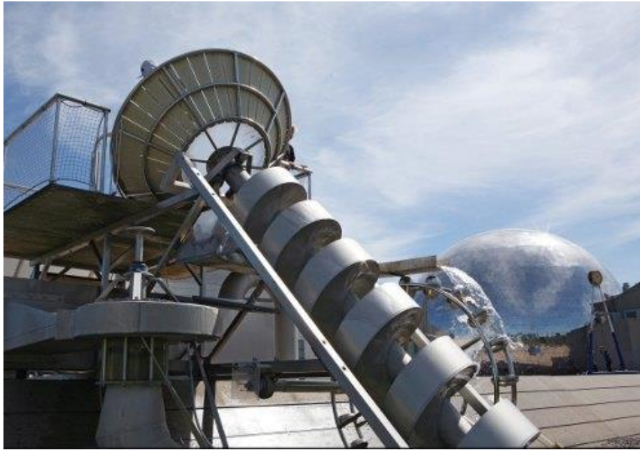
Фото. Архимедов винт, подающий воду из нижних водоемов в парке «Галилей»
